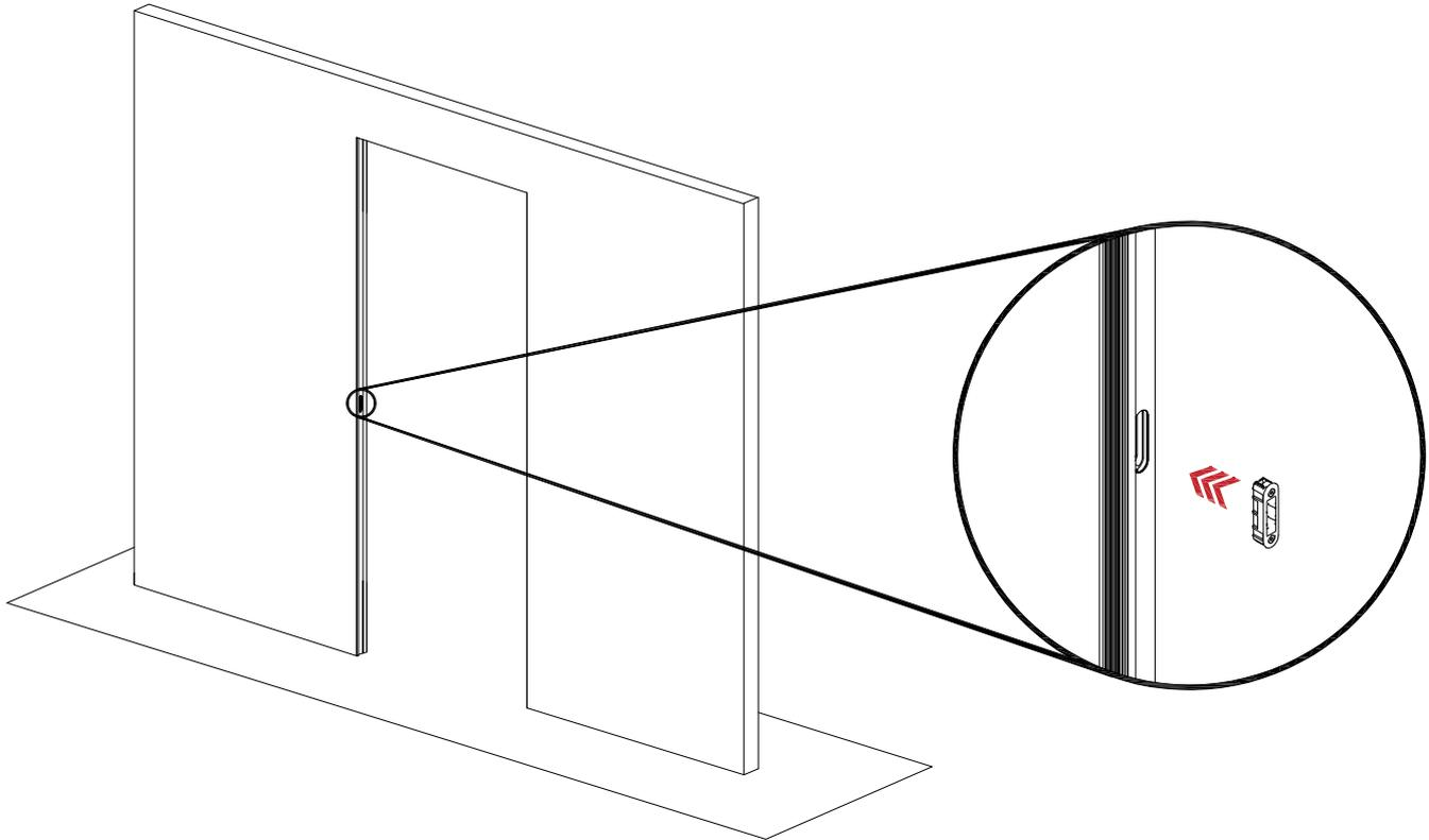
MONTAGGIO GUARNIZIONE DI BATTUTA
