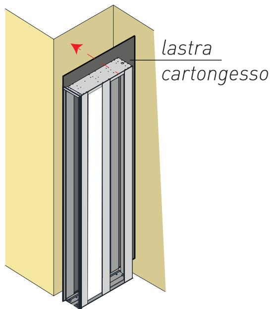
In caso di installazione del controteelaio in adiacenza ad una parete, procedere fissando una lastra di cartongesso sulla faccia del controteelaio che va contro la parete. La lastra si fissa direttamente sui montanti, usando viti per cartongesso di lunghezza massima 19mm.
