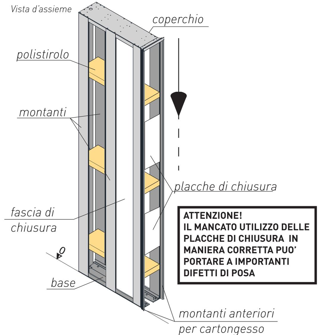
**NON RIMUOVERE LE PLACCHE E IL POLISTIROLO ALL'INTERNO, (facilitano la posa delle lastre di cartongesso). RIMUOVERLI UNA VOLTA ULTIME LE OPERAZIONI DI STUCCATURA E VERNICIATURA.**
