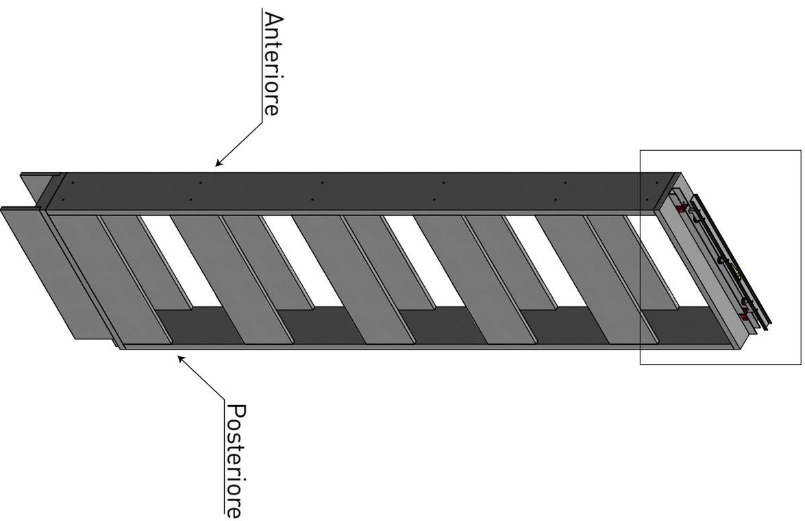
Una volta estratta la parte terminale della guida, inserirla nel profilo a "U" presente nella parte superiore del modulo Bigfoot, in questo modo sarà più facile inserire il modulo all'interno del controlaio.
