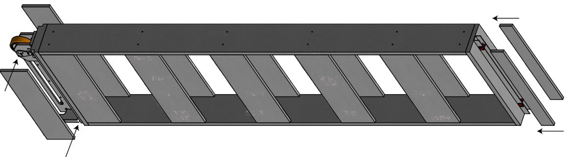
Una volta inserito il Bigfoot si può procedere a fissare i traversi di chiusura superiori e inferiori. Entrambi si incastrano con le spinette in legno presenti sui traversi del modulo Bigfoot.
