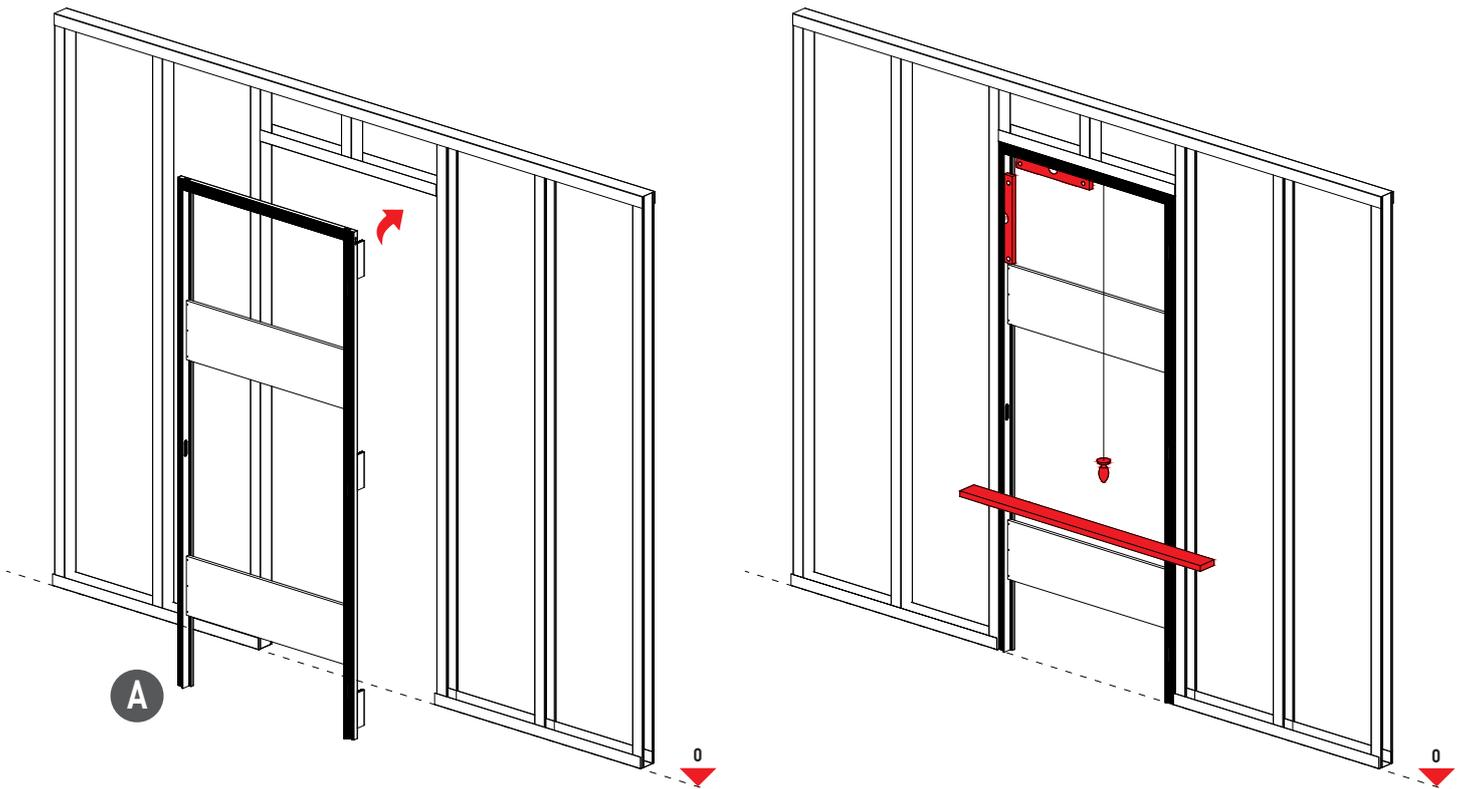
Fissare il telaio alla struttura scegliendo una fra le soluzioni illustrate di seguito. **Attenzione,** applicare le viti, sia sui montanti, che sul traverso superiore.
